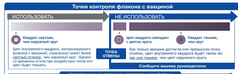
Флаконные термоиндикаторы находятся на этикетке вакцины против коклюша, дифтерии, столбняка и гепатита В адсорбированной, поставляемой Серум Институтом оф Индия Pvt. Ltd. Это чувствительная к температуре-времени точка, показывающая аккумулированное тепло, воздействующее на флакон. Она предупреждает конечного потребителя о том, что воздействие тепла, вероятно, привело в негодность вакцину сверх допустимого уровня.
