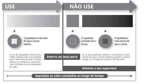
A interpretação do VVM é simples. Concentre-se no quadrado central. Sua cor vai mudar progressivamente. Enquanto a cor deste quadrado for mais clara que a cor do círculo, a vacina pode ser usada. Assim que a cor do quadrado central for da mesma cor do círculo ou de uma cor mais escura que o círculo, o frasco deve ser descartado.
